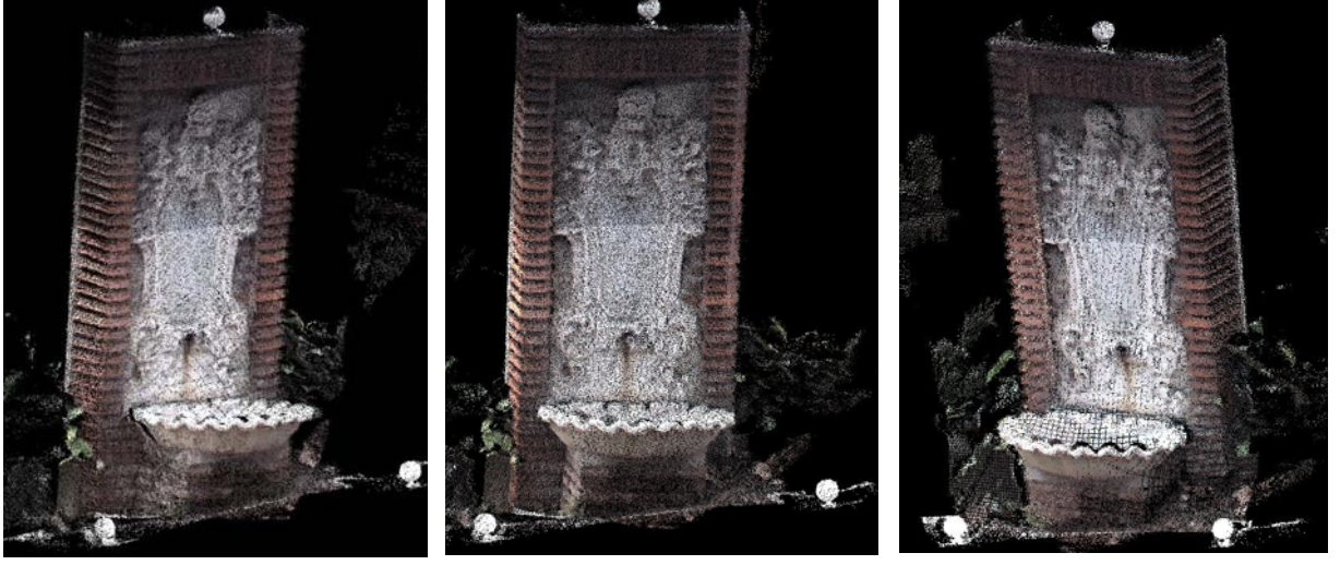
Şekil 6: Yersel lazer tarayıcı ile taranan tarihi çeşmeden farklı görüntüler
