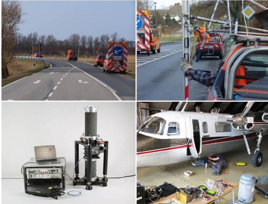
Şekil 10: Motorize nivelman araç ve gereçleri, FG5-X mutlak gravimetresi ve hava gravimetresi.
