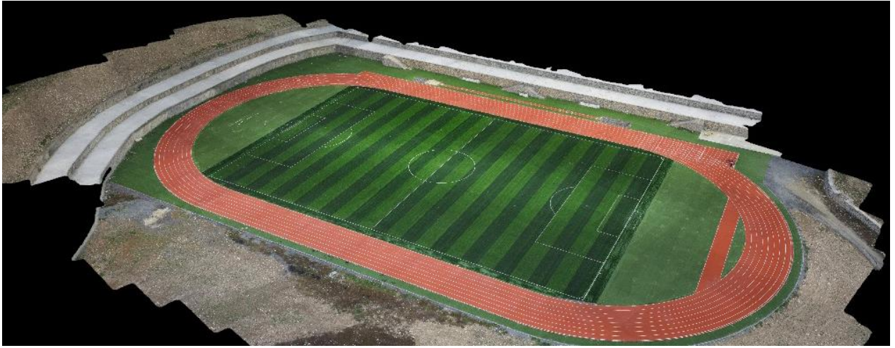
Şekil 6. İHA yardımıyla elde edilen fotoğraflardan üretilen nokta bulutundan üretilmiş katı model
