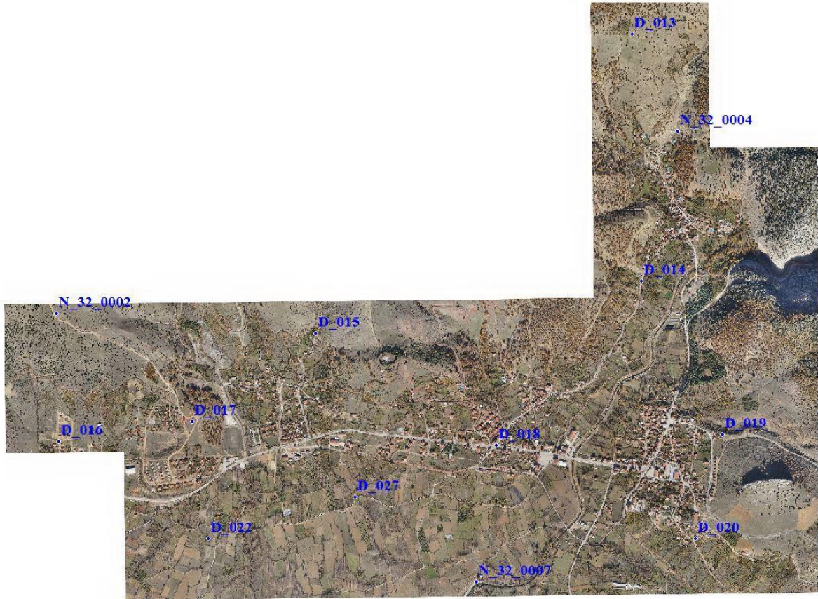
Şekil -6 Hava kameralı uçaktan çekilen fotoğraflarla üretilen true ortofoto
