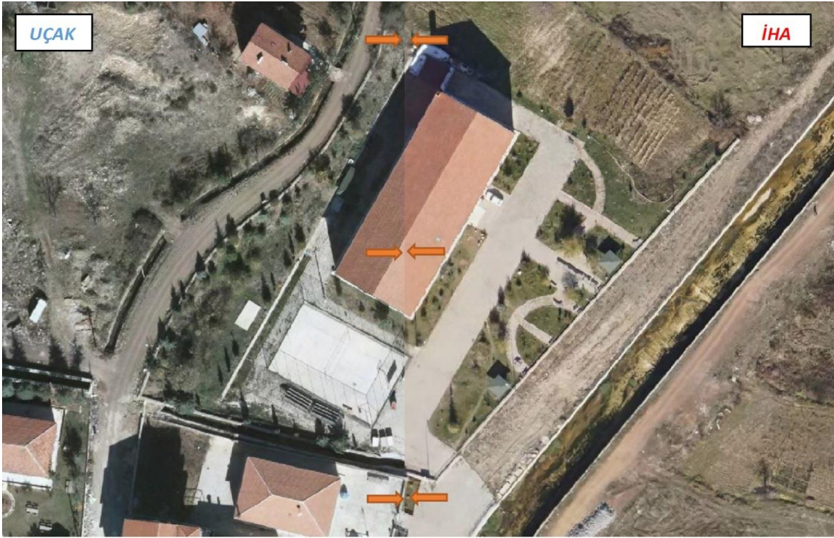
Şekil-10 Üretilen ortofotoların bindirmeli bir şekilde karşılaştırılmış görüntüsü
