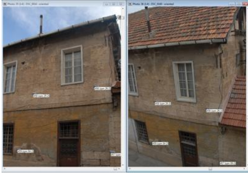
Şekil 5. Kontrol noktalarının işaretlenmesi
