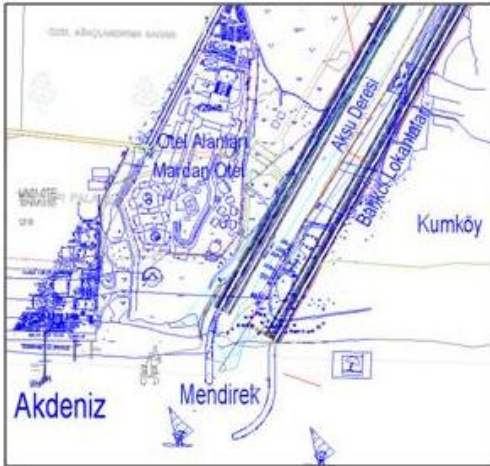
Şekil 5. Antalya Aksu deresi mendirek inşaatı ve dere ıslahı kapsamında 180 metrelik yeni dere güzergahı
