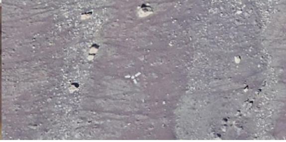
Şekil 9: Uçaktan alınan görüntü üzerinde Yer Kontrol Noktası
